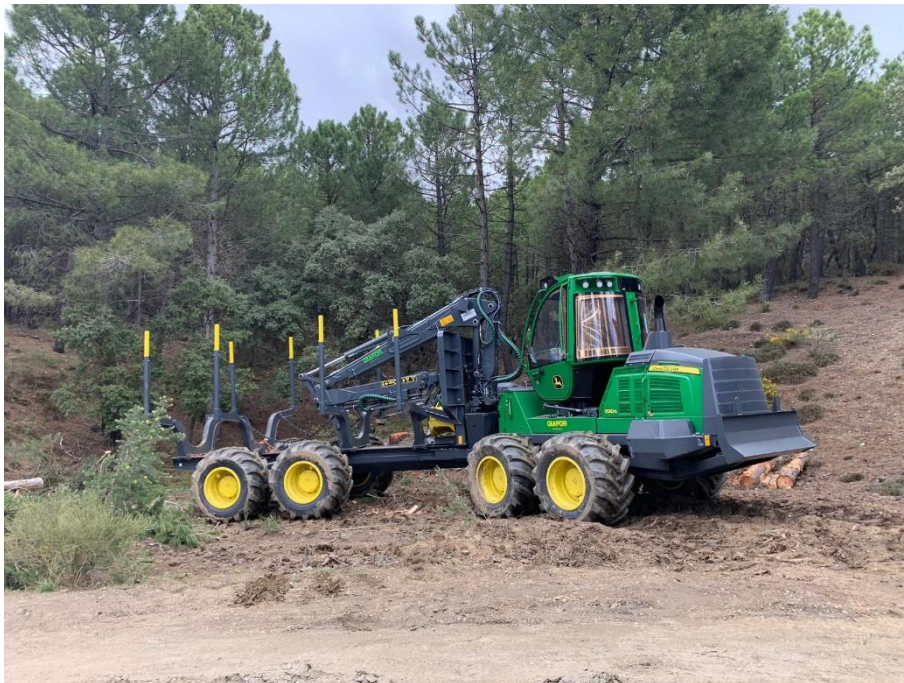
Fotografía 17: Tractor autocargador. (La Cal Herrera J. A.).
