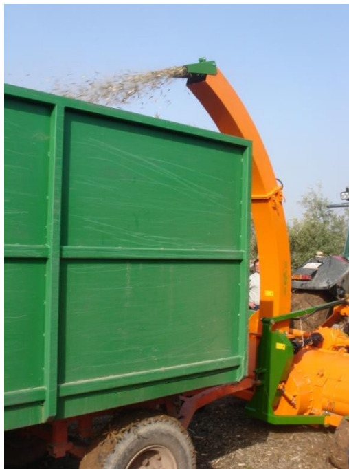
Fotografía 24: Astilladora acoplada a tractor. (La Cal Herrera J. A.)
