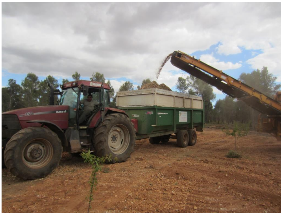
Fotografía 2: Astillado y carga de residuos forestales en campo (La Cal Herrera J. A.).
