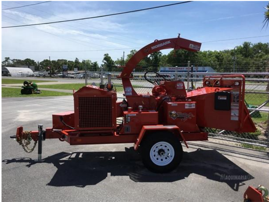
Fotografía 20: Astilladora sobre chasis de ruedas y remolcada. Morbark.
