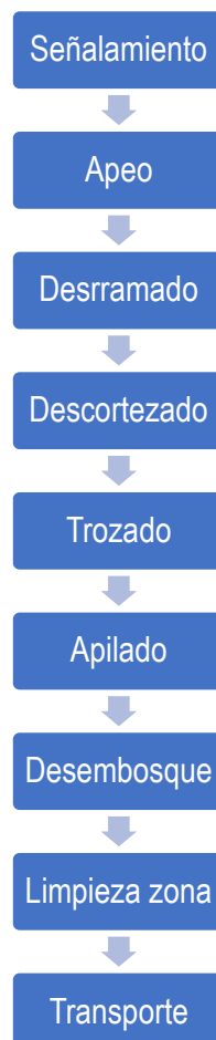
Figura 6: Secuencia típica de un aprovechamiento forestal. (La Cal Herrera J. A.)
