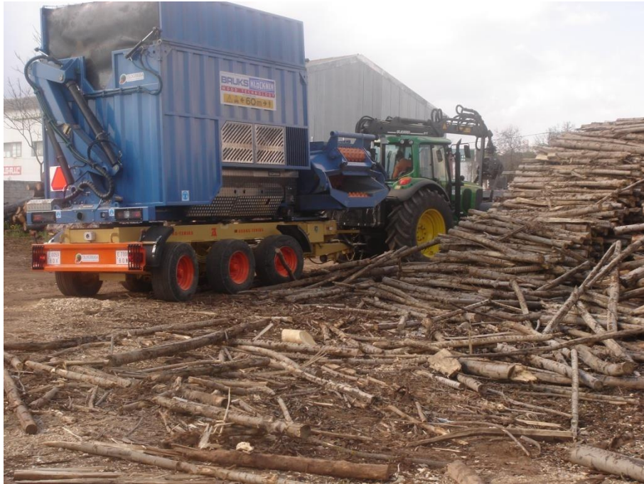
Fotografía 22: Astilladora autoalimentada sobre autocargador. (La Cal Herrera J. A.)
