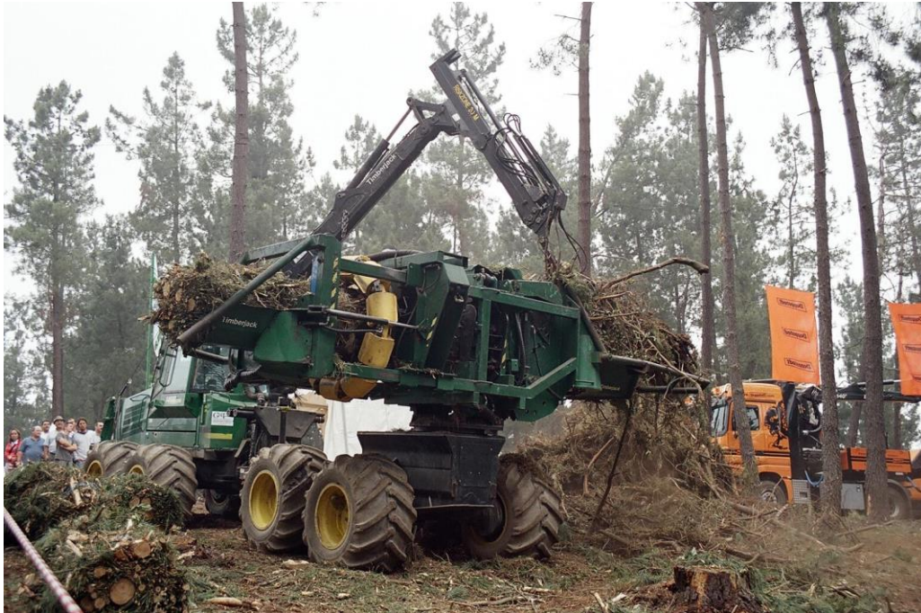
Fotografía 25: Empacadora forestal (La Cal Herrera J. A.)
