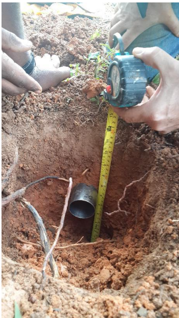
Foto 3. Muestreo de densidad aparente, a partir de 15 cm de profundidad, con un tubo de volumen conocido
