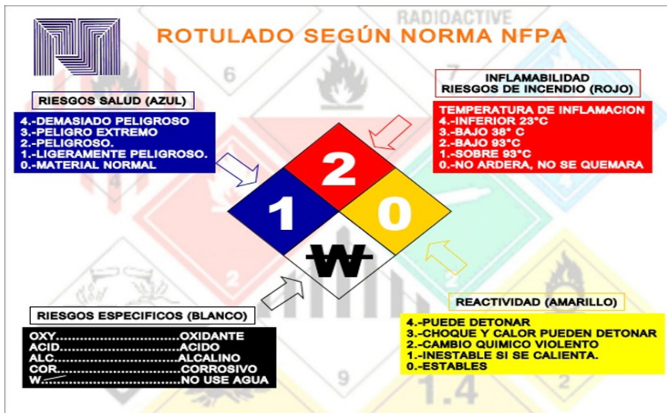
Figura No. 15: Rotulado según Norma NFPA
