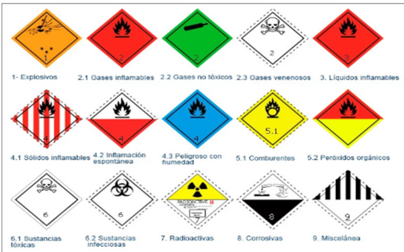
Figura No. 17: Etiquetas y categorías de peligros del ADR
