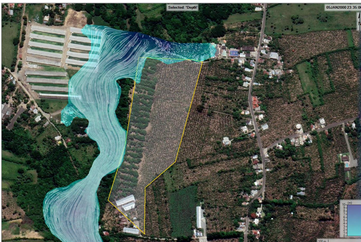
Figura 3.17. Simulación hidráulica de la inundación producida por la crecida con tiempo de retorno de 100 años en el área del proyecto.
