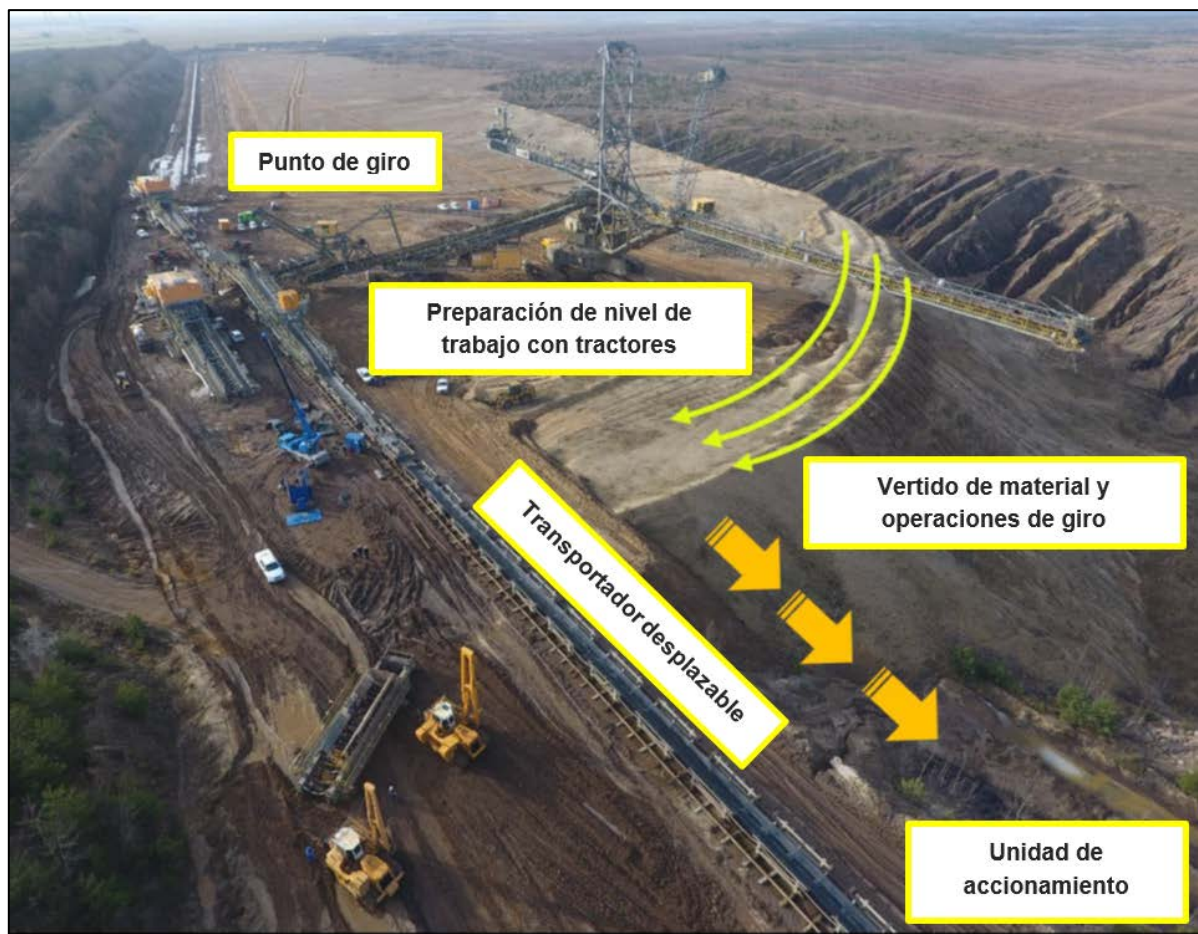
Figura 1.26: Ejemplo de operaciones típicas de sistemas de apilamiento
