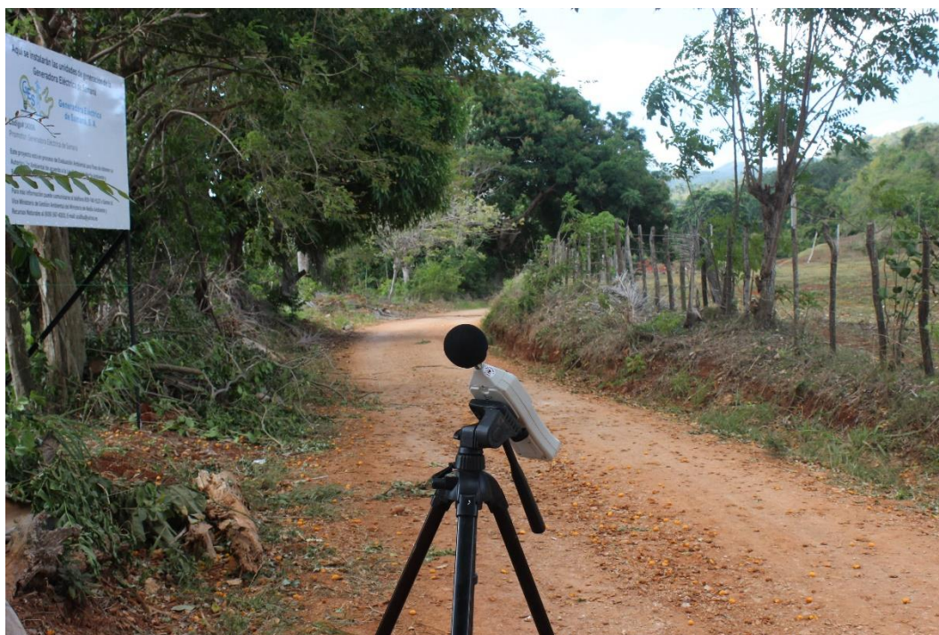
Foto 2. 1 Toma de ruidos en punto R1, en el camino de acceso a la parcela, frente al letrero del proyecto
