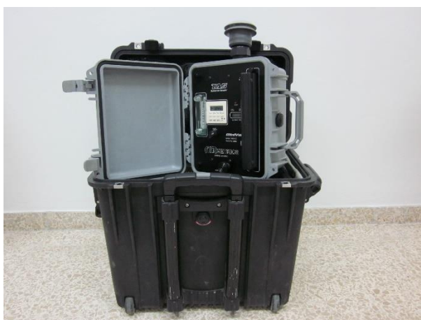
Foto 5.1-2. MiniVol TAS para mediciones de la concentración de material particulado en el aire.
