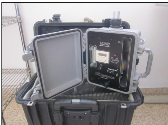
Foto 6.3-1. Medidor portátil de material particulado Minivol TAS de Air Metrics (archivos Empaca).
