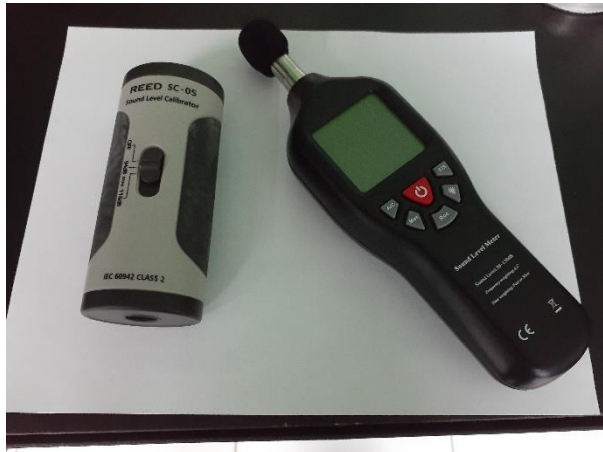
Foto 4.1-2. Calibrador acústico REED Modelo 12777-836 clase 2 IEC 60942 No. 12030026 utilizado para las calibraciones de campo del sonómetro utilizado, previo a las mediciones de los niveles de ruido
