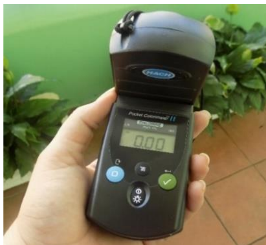
Foto 7.1-3. Equipo portátil Hach Colorimeter II para mediciones in situ de parámetros de cloro libre y total.
