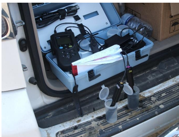
Foto 7.1-1. Equipo portátil Hach HQ40d para mediciones de parámetros fisicoquímicos in situ de las aguas y efluentes.
