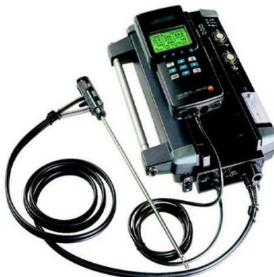
Foto 6.1-1. Equipo TESTO 350 XL utilizado en las mediciones de concentraciones de gases de combustión en la chimenea del generador de electricidad de emergencia de 500 kW.
