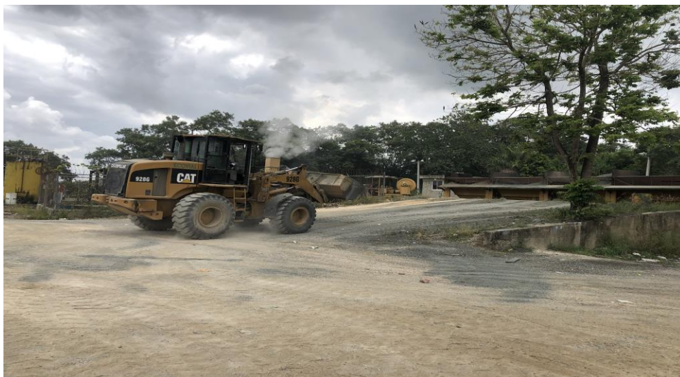
Foto No. 5.- Pala mecánica utilizada para alimentar la tolva de la planta de hormigón
