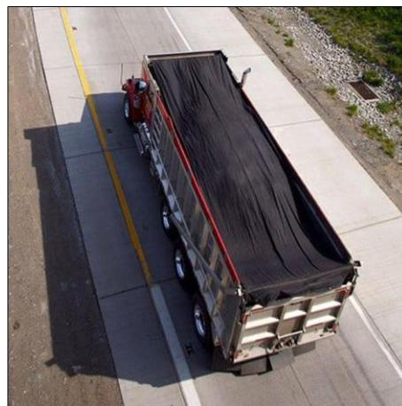
**Foto 6.3-1.** Vistas de la forma en que se deben cubrir los camiones que transporten agregados y materiales de construcción hacia el solar donde se construirá el proyecto.
