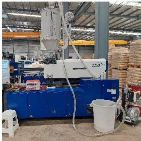
Fotos 1.2.5.3-1. Manguera utilizada para succionar la materia prima.
