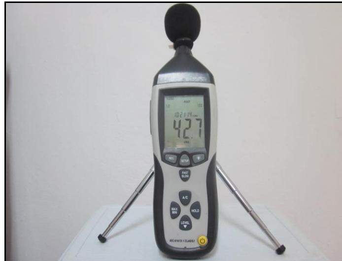
**Foto 5.4-1.** Analizador digital de ruido marca CEM DT-8852.
