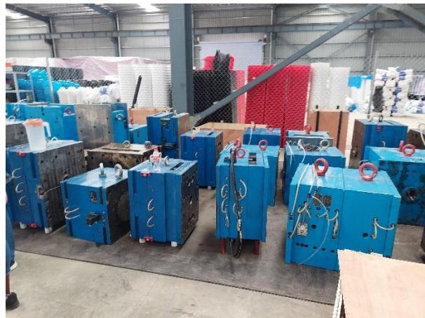
**Fotos 1.2.3.1.1.1-2.** Molden para la fabricación de productos.
