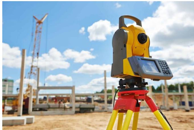
**Foto 1.2.2.2.2-1.** Estación total como equipo básico para los replanteos de los objetos de obra en el proyecto.
