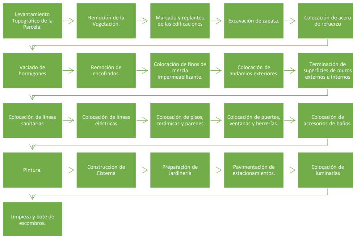
Figura No.7. Flujograma de construcción de viviendas
