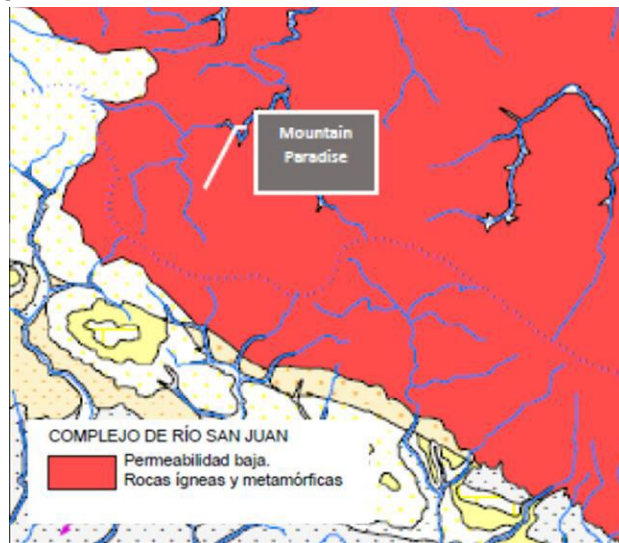
Figura No. 4- Esquema hidrogeológico o Sistema de drenaje transcurriendo por lecho de rocas impermeable.
