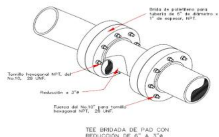
Figura 19 Tee Bridada con reducción de 6 a 3"
