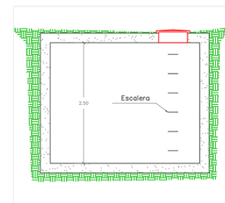
SECCIÓN CISTERNA A-A'' Escala: 1:50
