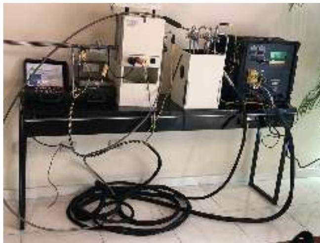
*Foto 6.10.6.4-6. Equipamiento XC-5000 utilizado en la medición de la concentración de material particulado en condiciones isocinéticas en las chimeneas (Foto de Archivo).*
