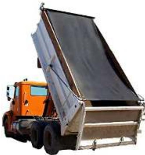
*Foto 6.5.1-2. Vista de camión de volquete de agregados con una lona (Archivos Empaca).*
