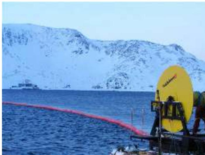
*Foto 6.9.3.4-2. Ejemplo de barrera de contención autoinflables para la contención de derrames de hidrocarburos en el mar (tomado de <https://markleen.com>).*
