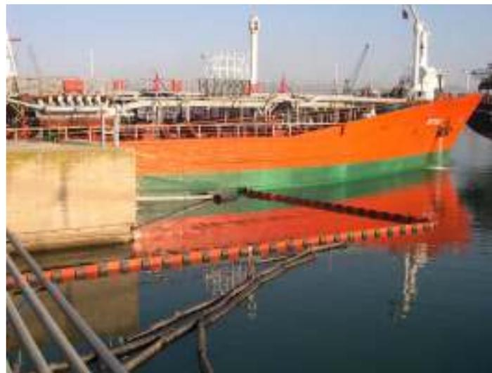
*Foto 6.9.3.4-3. Ejemplo de barreras flotantes con flotadores rígidos para la contención de derrames de hidrocarburos en el mar (tomado de <https://markleen.com>).*
