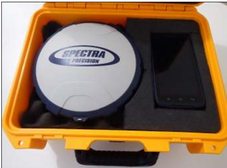
**Foto 2.2.1-2.** Sistema GPS Trimble Spectra Precision SP60 (archivos Empaca).
