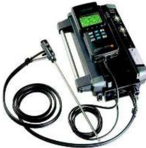
*Foto 6.10.6.4-5. Analizador portátil de gases TESTO 350 XL (Foto de Archivo).*
