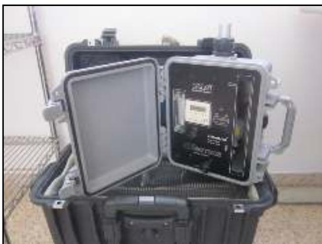
*Foto 6.10.6.4-2. Medidor portátil de material particulado Minivol TAS de Air Metrics.*
