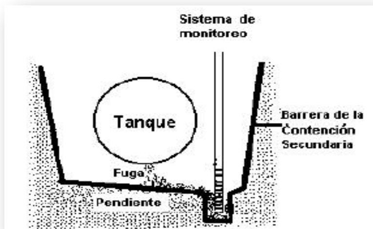
Fig. 60. Contención secundaria con monitoreo. Adaptado de EPA, 1995.
