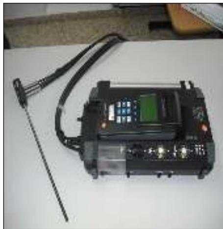
Foto 6.6.3.3-1. Analizador portátil de gases TESTO 350 XL de fabricación alemana (archivos Empaca).
