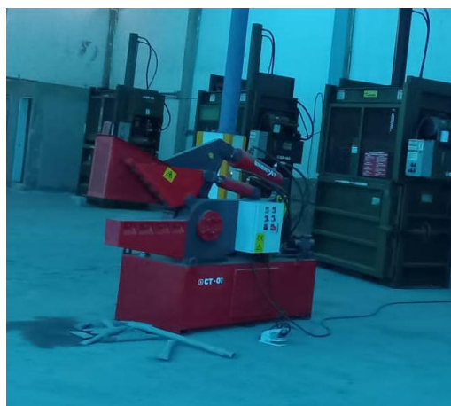
Foto 2.1.8 Cortadora de 30 toneladas de presión
