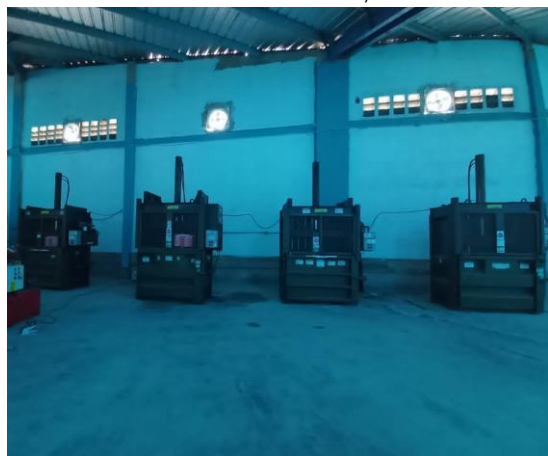
Foto 2.1.9 Compactadoras de 20 toneladas de presión
