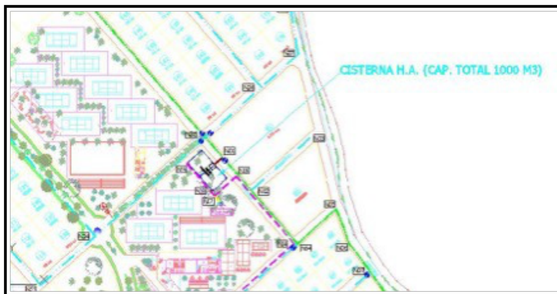
Figura No I-8 Mostrando El Campo De Pozos y La Línea De Impulsión.
