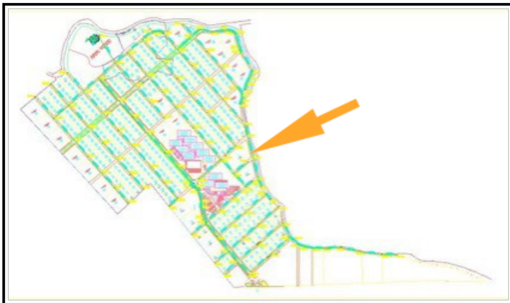
Figura No I-9 Mostrando Las Redes De Recolección De Las Aguas Residuales (flecha amarilla)
