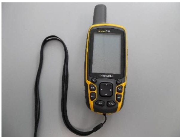
Foto 2-1. GPS Garmin para la georreferenciación de los puntos de monitoreo en coordenadas UTM.
