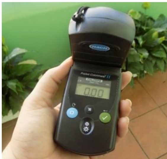
Foto 7.1-3. Equipo portátil Hach Colorimeter II para mediciones in situ de parámetros de cloro libre y total.
