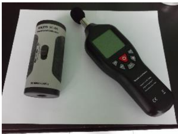
Foto 4.1-2. Calibrador acústico REED clase 2 IEC 60942 utilizado para las calibraciones de campo del sonómetro utilizado, previo a las mediciones de los niveles de ruido.
