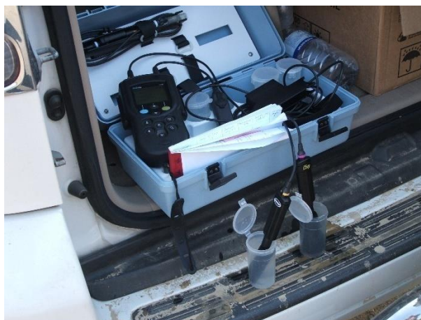
Foto 7.1-1. Equipo portátil Hach HQ40d para mediciones de parámetros fisicoquímicos in situ de las aguas.
