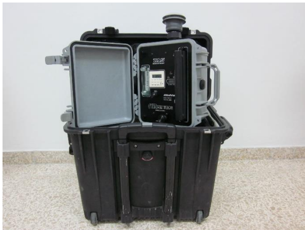
Foto 5.1-1. MiniVol TAS para mediciones de la concentración de material particulado en el aire.
