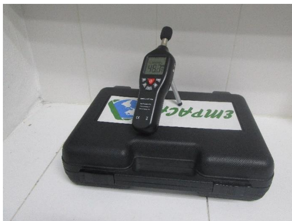
Foto 4.1-1. Sonómetro data logger GENERICO-NMN para mediciones de los niveles de ruido.
