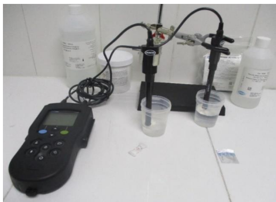
Foto 7.1-2. Utilización de las sondas Hach para mediciones de concentraciones de cloruros y nitratos.
