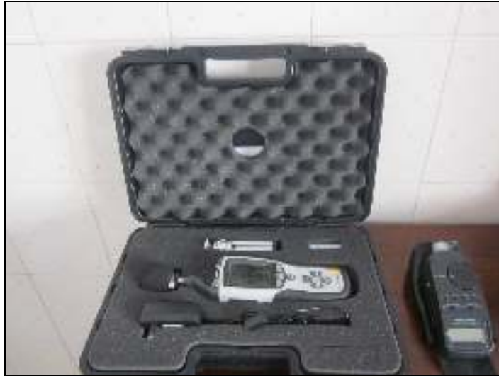
Foto 6.4-1. Sonómetro digital de ruido CEM DT 8852 (archivos Empaca).
