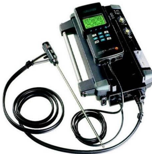
Foto 6.1-1. Equipo TESTO 350 XL utilizado en las mediciones de concentraciones de gases de combustión en las emisiones atmosféricas
