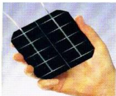
Célula de silicio monocristalino
