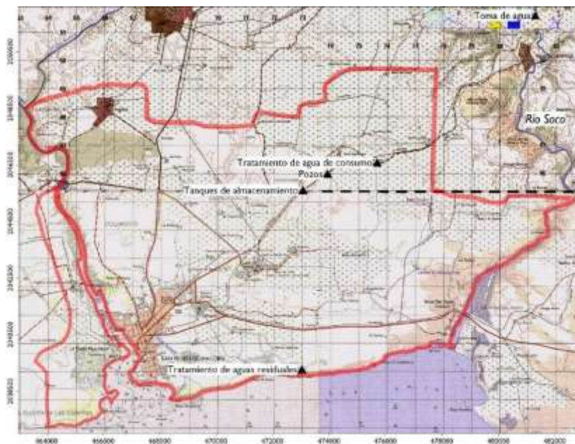
Ilustración 22 Elementos del sistema público de suministro de agua en el Municipio San Pedro de Macorís sobre la Hoja Topográfica. Fuente: Georreferenciación durante viaje de campo de ICMA y ICF
