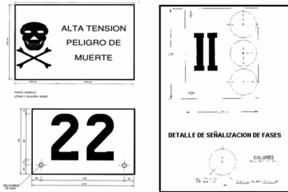
Figura 2.14. Placas de numeración, peligro e identificación de fases
