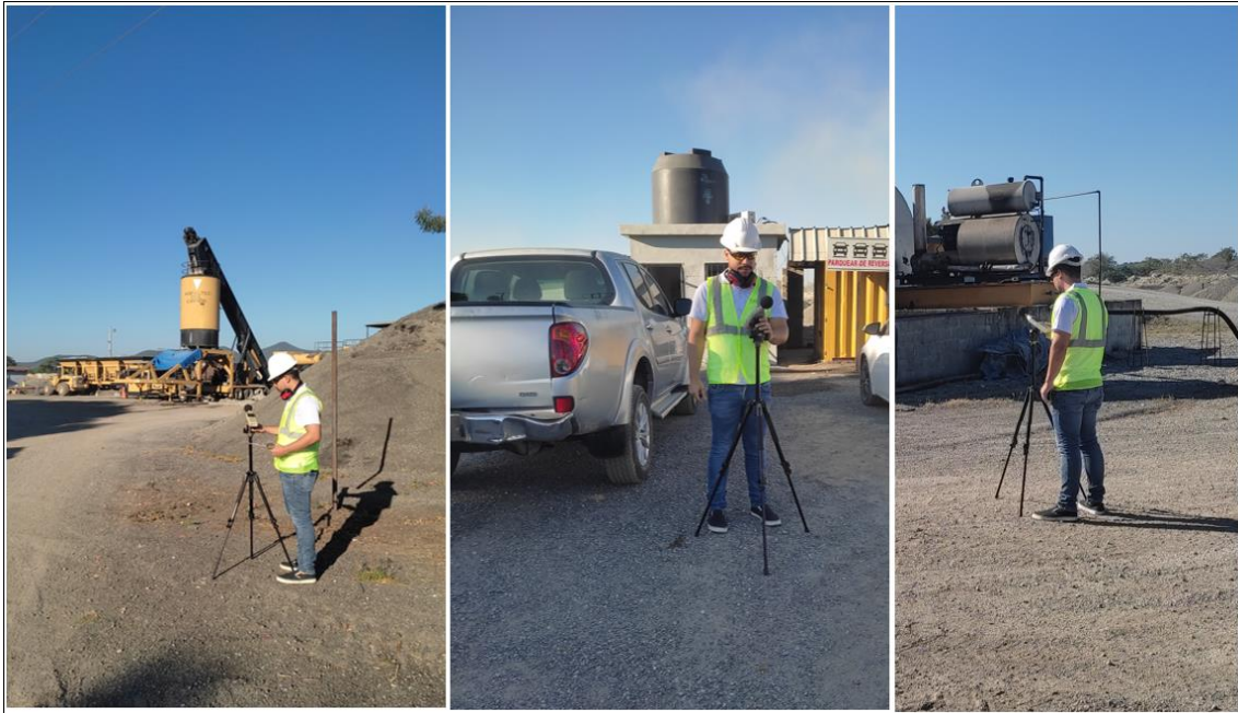
Imagen 4. Medición de los Niveles de Ruido en el Perímetro Interno y Exteriores
