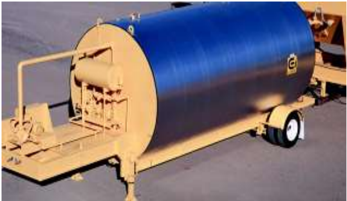
Vista del tanque de calentamiento y almacenamiento de líquido asfáltico
