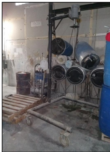
Imágenes 2.15 – 2.16. Vista del área de producción con las mezcladoras de líquido fija y móvil.
