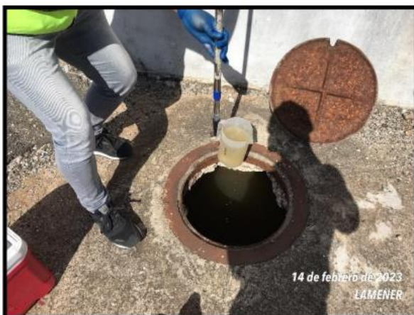
Imágenes 6.1 – 6.2. Técnico de LAMENER tomando la muestra de aguas residuales del séptico. Fuente: LAMENER.
