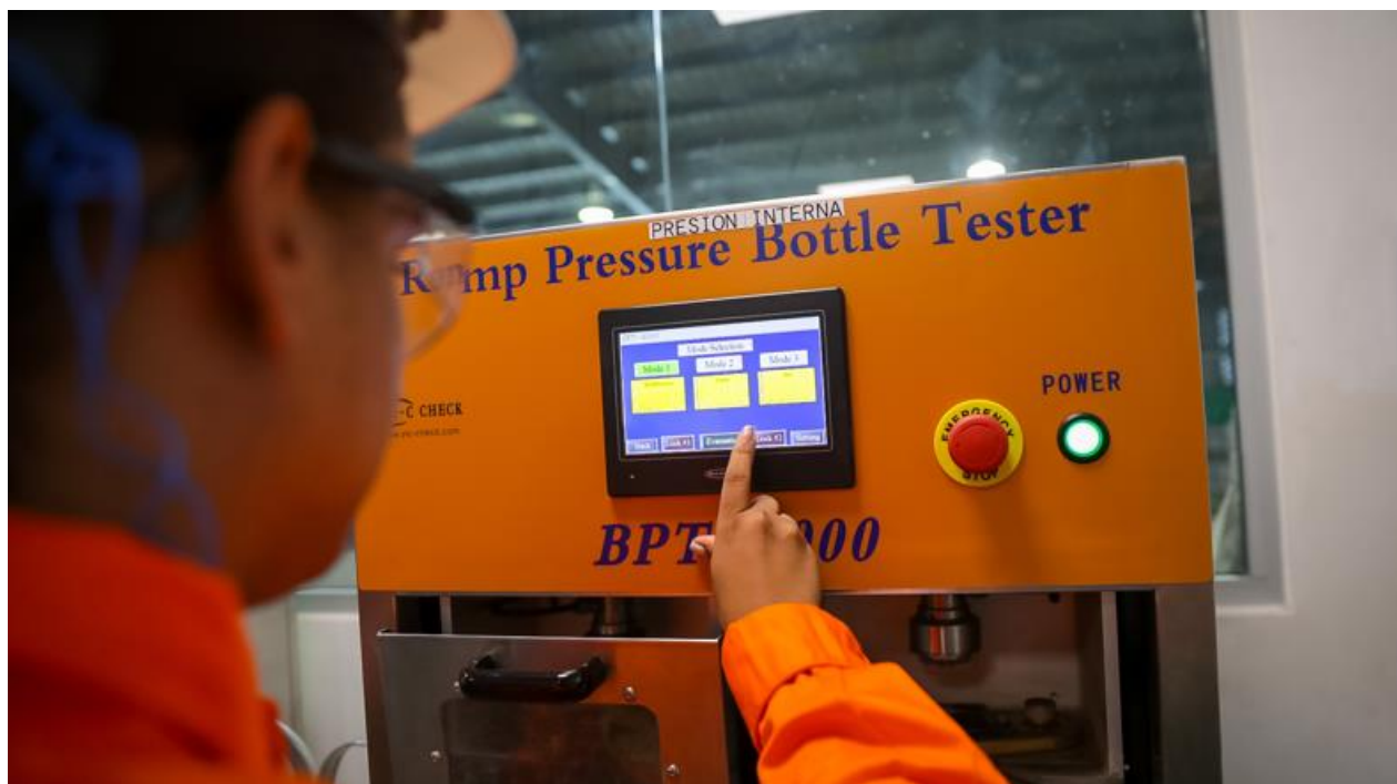
Imagen 13.- Medición presión interna en laboratorio
