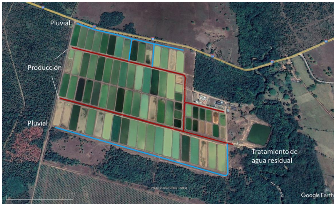
Fotografía 7. Canales de drenaje de agua de los estanques de producción de peces (en rojo o producción) y canales para evacuación de agua de lluvia (azul o pluvial).
