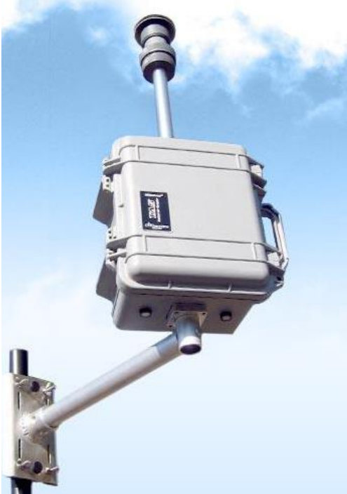
Fotografía 10. Ilustración de la instalación del Air Metrics-MiniVol TAS.
