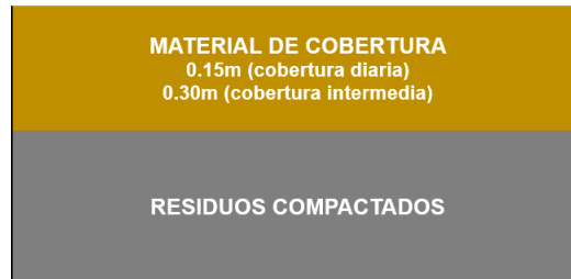
Figura 15. Esquema de la cobertura diaria con material adecuado
