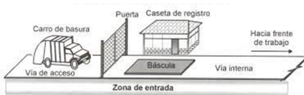
Figura 4. Distribución área de entrada del SDF
