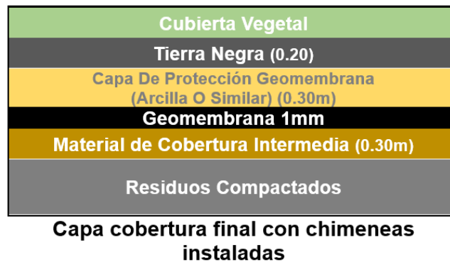
Figura 16. Esquema de la cobertura final
