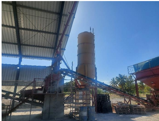
Foto 1.2.4-4. Mezcladora para mezclar las materias primas utilizada en la fabricación de blocks.
