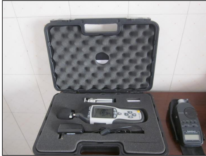
Foto 7.4-1. MINI Sound Meter SPER SCIENTIFIC 850014.
