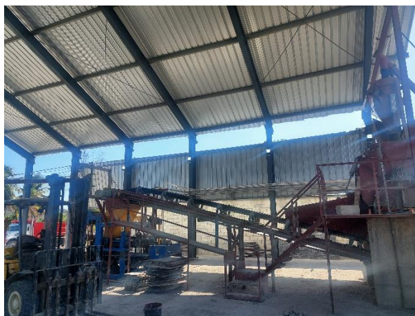
Foto 1.2.4-5. Conveyor utilizado para el trasporte de la mezcla hasta la máquina de blocks.
