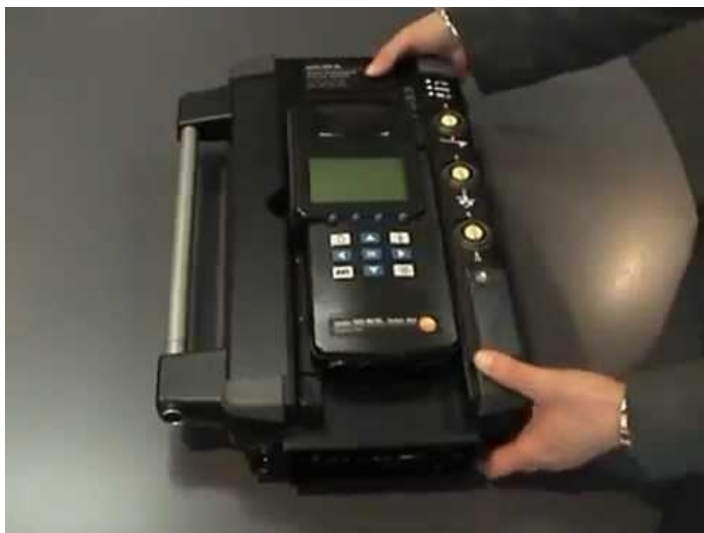
Foto 7.3-1. Analizador de gases TESTO 350 XL.
