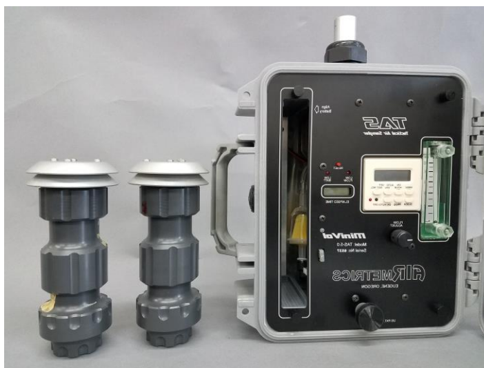
Foto 7.3-2. Medidor portátil de material particulado Minivol TAS de Air Metrics.
