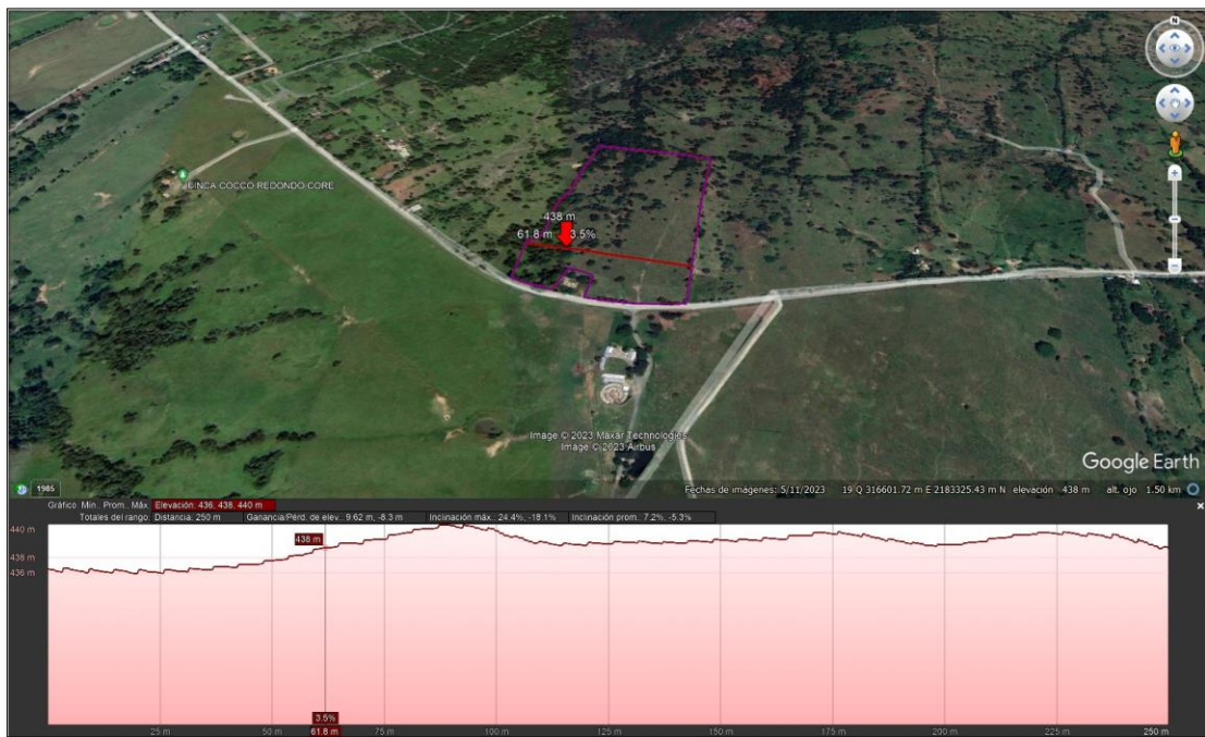
Imagen 3.9. Perfil de elevación del terreno del proyecto en dirección Este – Oeste. Rango 3.5%=10.2 grados.
