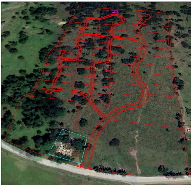
Imagen 3.29. Plano de conjunto sobre trazado sobre el terreno del proyecto. Se puede observar el trazado de las calles con respecto a la vegetación existente.
