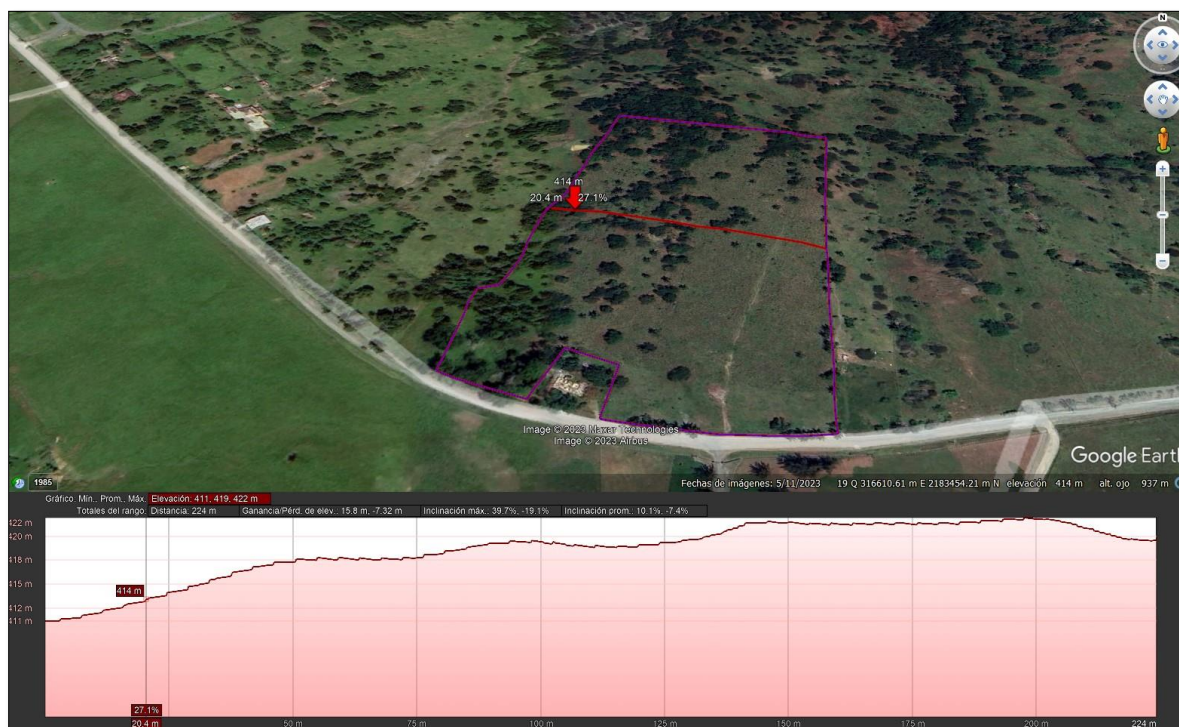
Imagen 3.8. Perfil de elevación del terreno del proyecto en dirección Este – Oeste. Rango 27%=15.4 grados.
