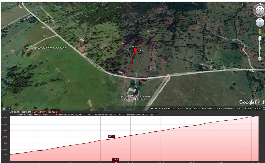
Imagen 3.10. Perfil de elevación del terreno del proyecto en dirección Norte – Sur. Rango 22%=12.9 grados.
