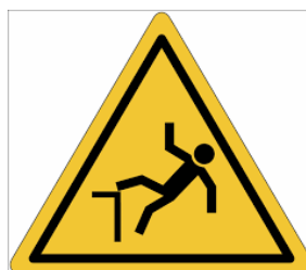
Riesgo de caída a distinto nivel
