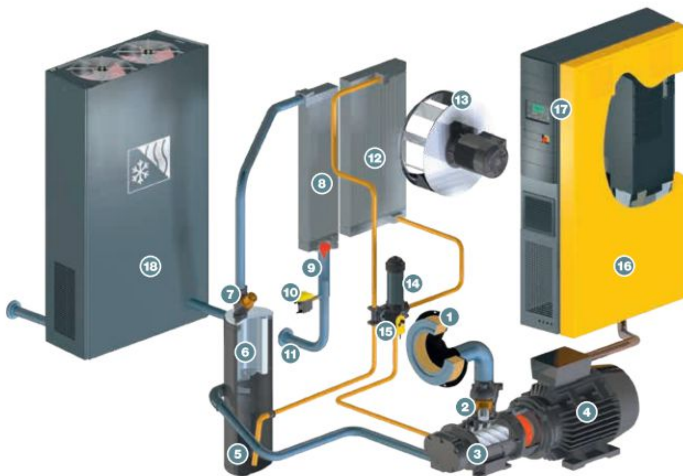
Gráfica 16- Diagrama configuracion sistema aire comprimido KAESER
