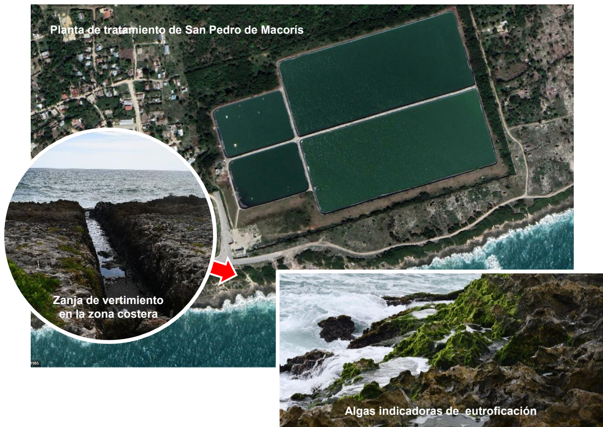
Foto 3.9. Zanja de vertimiento en la zona costera de las aguas residuales tratadas de la Planta municipal de tratamiento de aguas residuales de San Pedro de Macorís.
