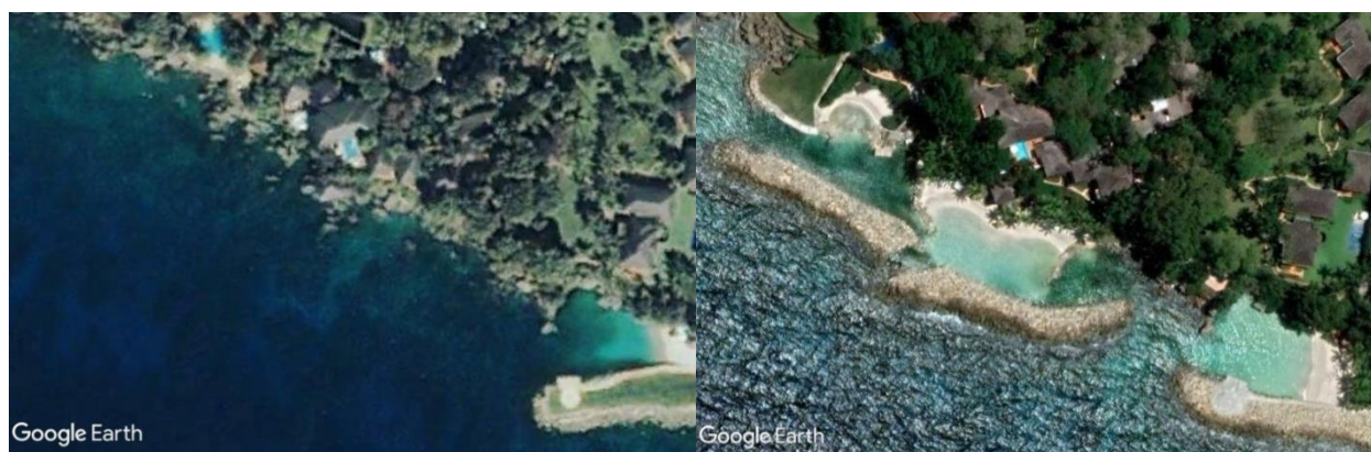
Foto 2.5. Ejemplo de transformación de la costa rocosa para la creación de playas artificiales a la altura de Costa Verde en La Romana, en la comparación de imágenes aéreas del 2004 (izquierda) y 2022 (derecha). Fuente: Google Earth.
