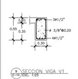
10 SECCION VIGA V1
