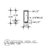
10 SECCION VIGA V2
