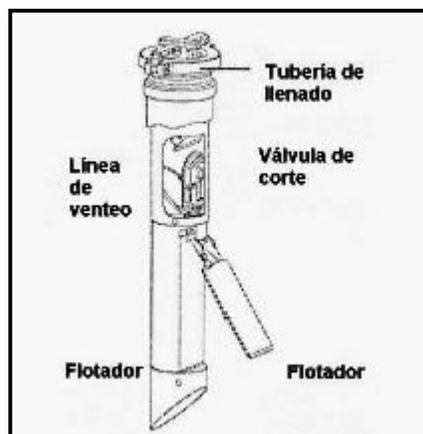
**Figura No. 38 Sistema automático de corte de suministro.**
