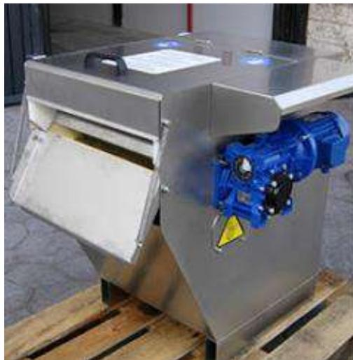
Figura 2. Ffotografía de un tamiz rotativo (ilustrativa)
