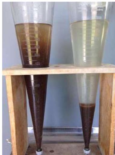
**Figura 8.** Prueba de sólidos sedimentables
