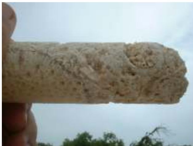
Foto 2.2.2-4. Presencia de corales dentro de una matriz carbonatada, dura.
