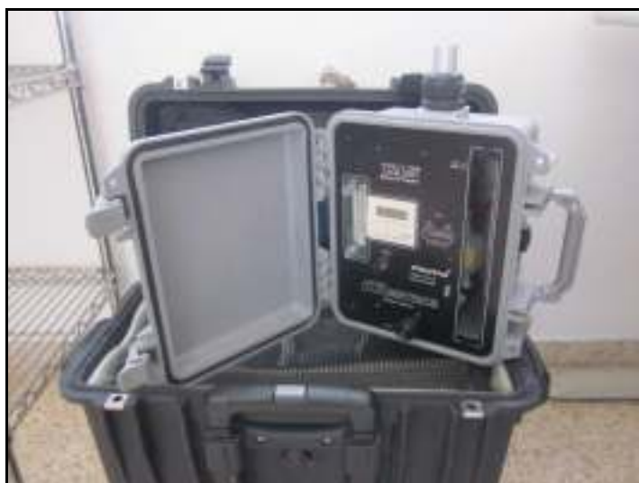
Foto 6.7.2.3-2. Medidor portátil de material particulado Minivol TAS de Air Metrics, aprobado por el Ministerio de Medio Ambiente y Recursos Naturales.
