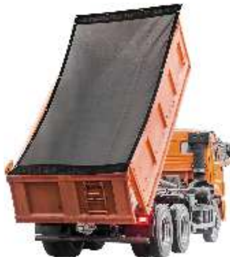
Foto 6.2.1.4-2. Ejemplo de camión con lona para transportar agregados ( https://www.amazon.com/-/es/HOMBYs-volquete-resistente-apertura-cubierta/dp/B0C9Q446MJ?th=1 ).
