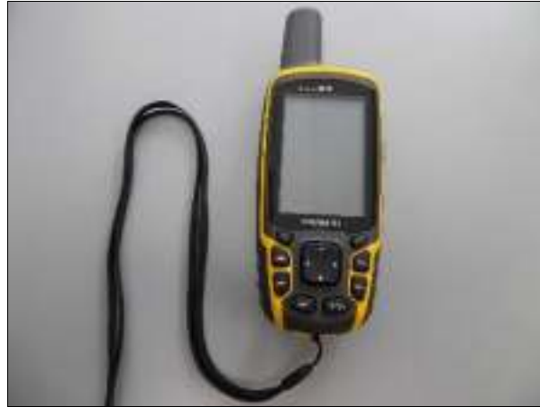
Foto 6.7.2.3-3. GPS Garmin para la georreferenciación de los puntos de monitoreo en coordenadas UTM.
