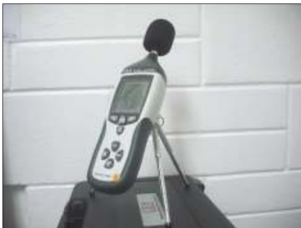
Foto 6.7.2.3-4. Sonómetro marca CEM DT-9952 (IEC-61672-1 CLASS 2).
