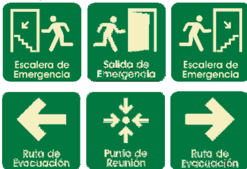
Figura 6.6.5.1-1. Señalizaciones indicando rutas de escape.
