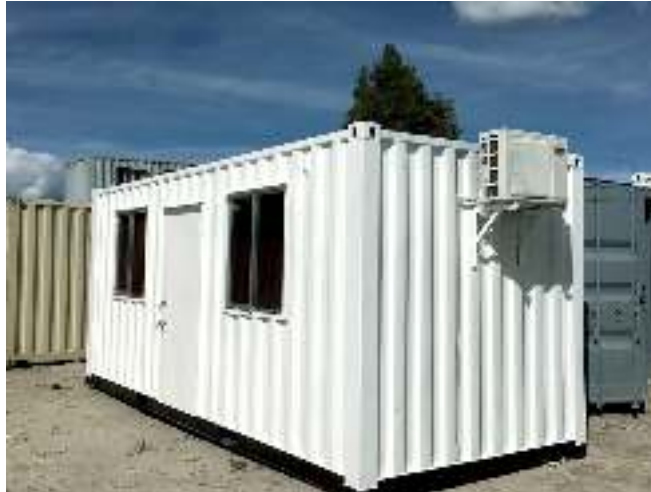
Foto 1.13.2.1-1. Tipo de furgón utilizado para oficina en una obra.
