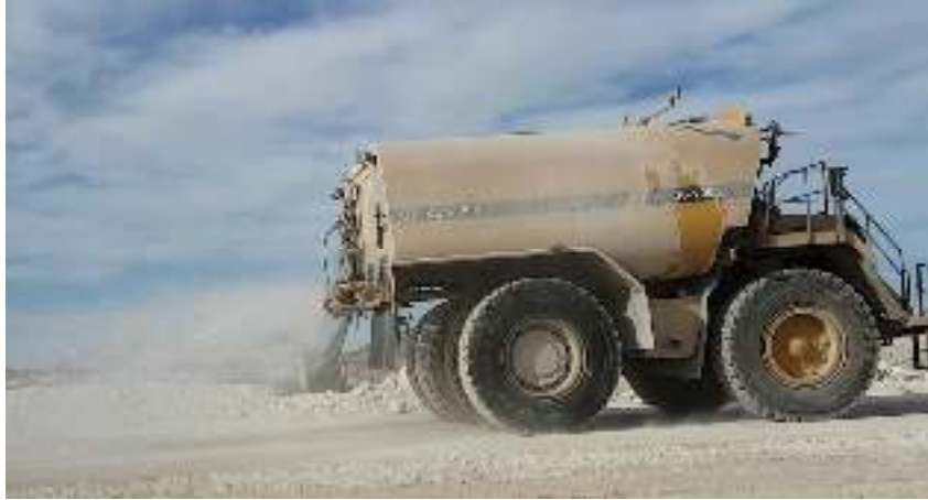
Foto 6.2.1.4-1. Ejemplo de camión cisterna para el humedecimiento de los caminos ( https://www.controldepolvo.es/mitigacion-del-polvo ).
