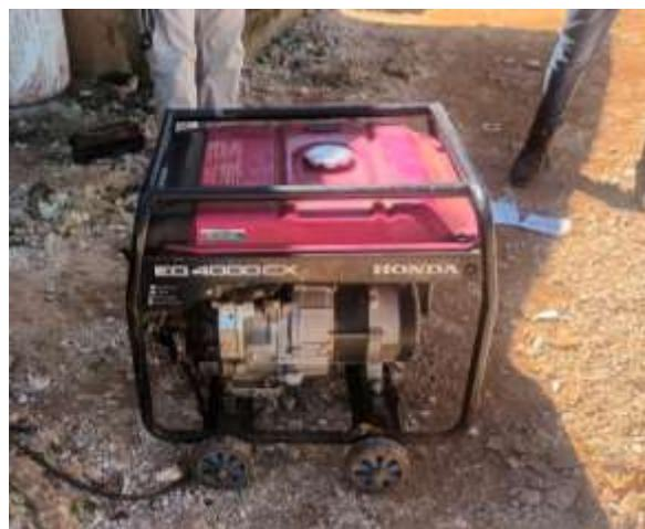
Foto No.42. Generador eléctrico de 4 Kva
