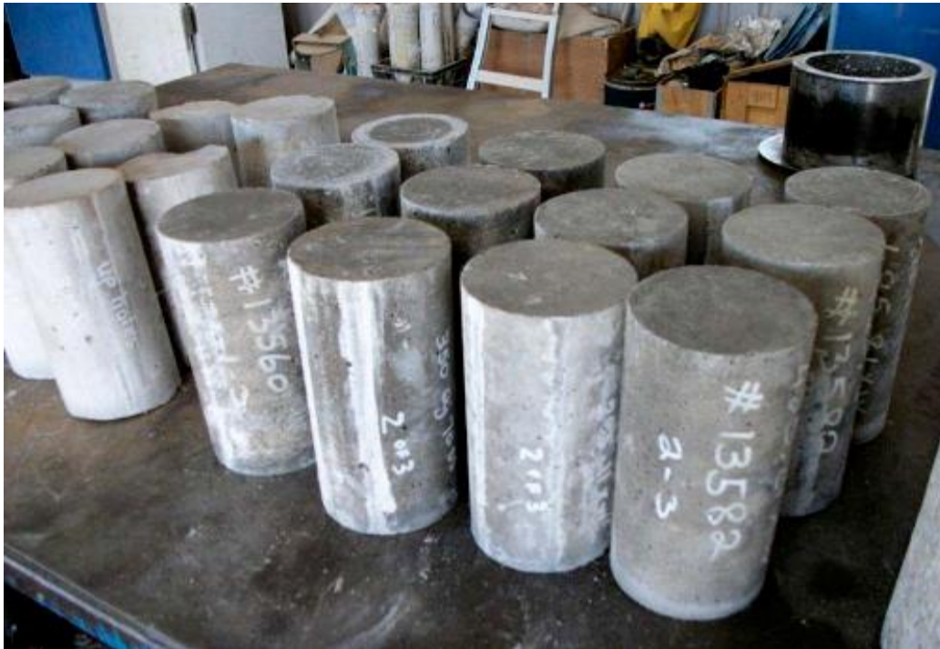
Foto No. 10.- Probetas para los análisis de resistencia
