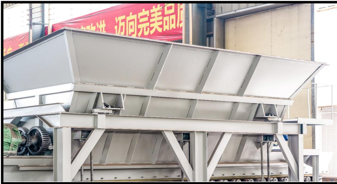
Foto No. 7.- Tolva y correa transportadora de la materia prima
