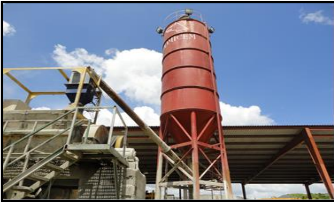
Foto No. 12.- Tipo de silo para el almacenaje del cemento
