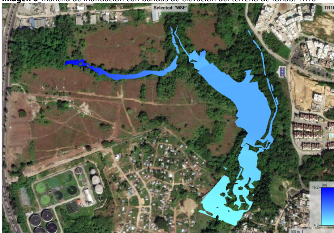
Imagen 9 _mancha de inundación con imagen satelital de fondo. TR10
