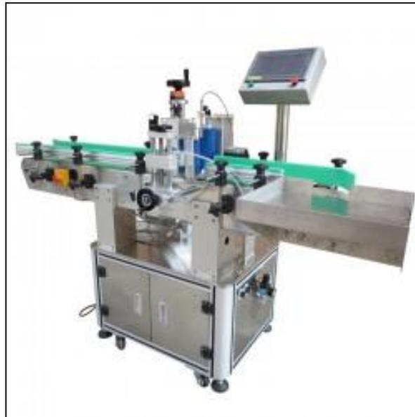
Foto 1.3.1.2-3. Máquina de etiquetadora.
