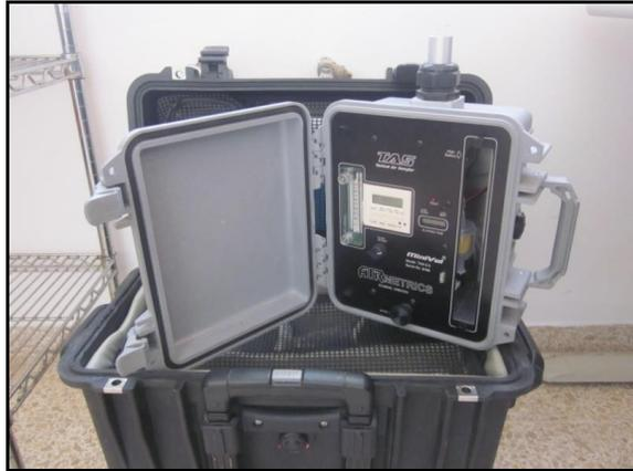
Foto 7.3-1. Medidor portátil de material particulado Minivol TAS de Air Metrics
