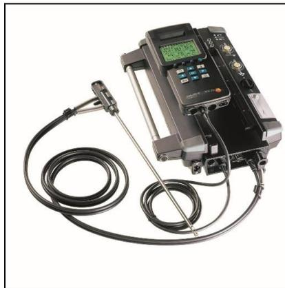
Foto 7.3-2. Analizador de gases TESTO 350 XL.
