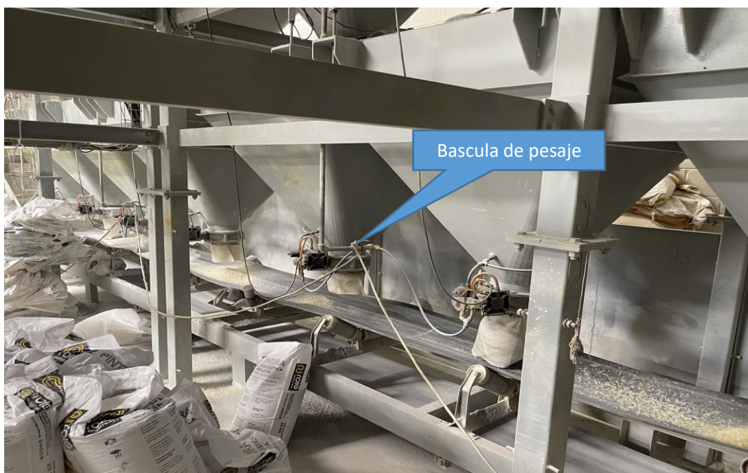
Foto No. 7.- Balanza o balanza de pesaje de los productos utilizados en el proceso
