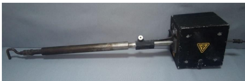
Figura 1. Muestreador de chimenea CAE (Clean Air Express)
