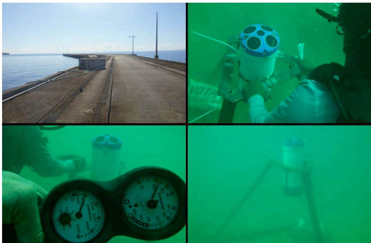
Imagen 10, 11, 12 y 13. Proceso de despliegue y colocación del perfilador de corrientes ADCP RDI Sentinel V50, con sensor de oleaje incorporado. Fuente: PDAB Port Investments Sociedad Gestora, SRL, 2023.
