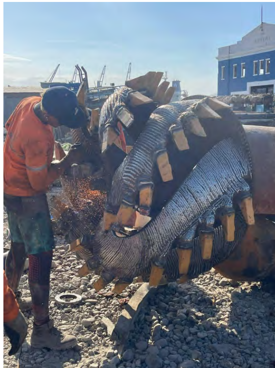
Imagen 67. Cortador sumergible tipo para una draga hidráulica estacionaria.
