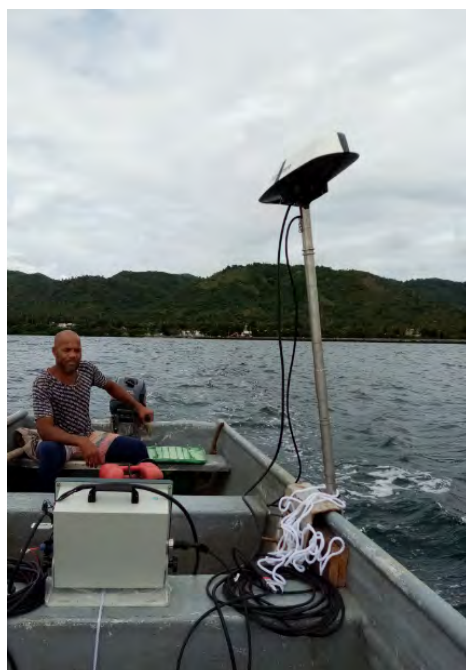
Imagen 58. Recopilación de puntos con equipos batimétricos.
