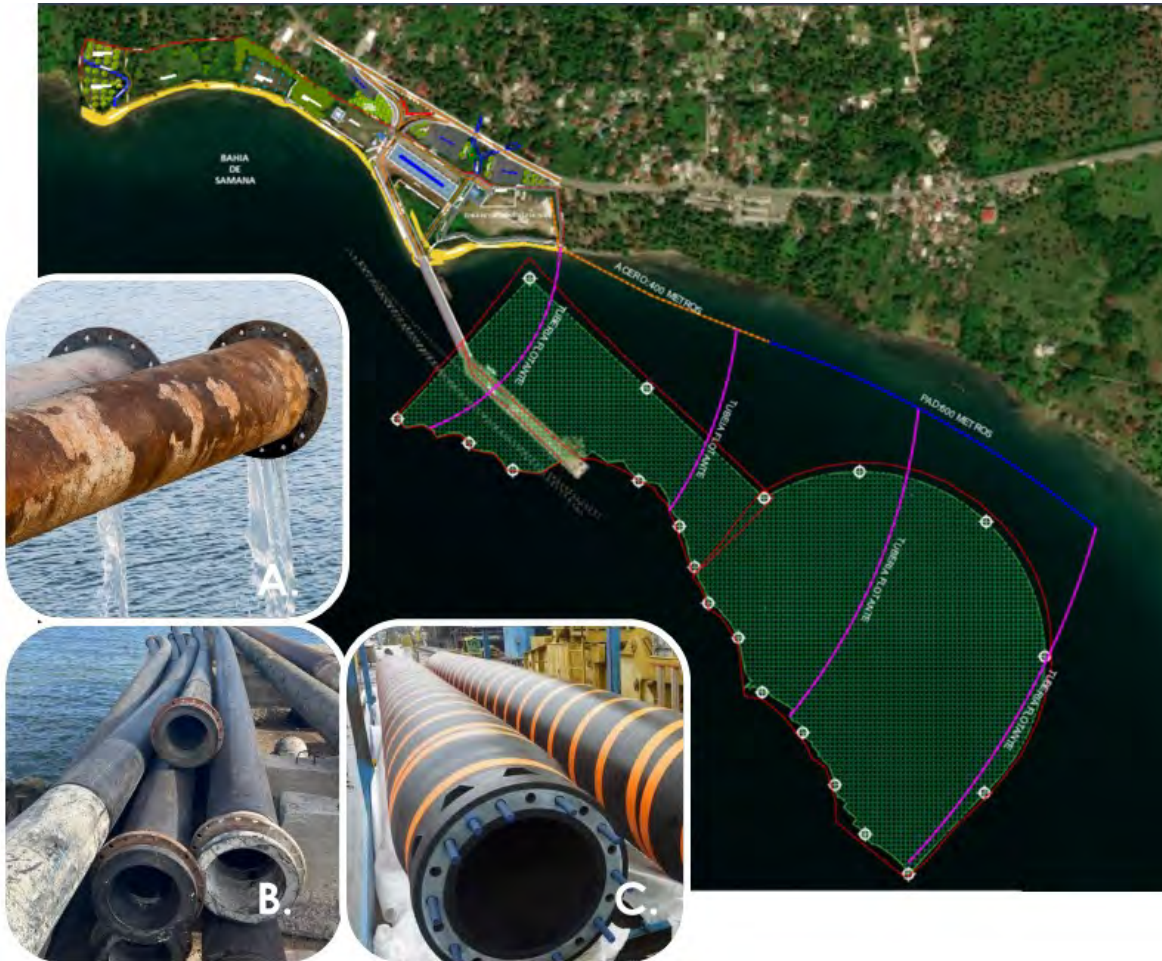
Imagen 343. Configuración de la línea de descarga en el espacio de dragado. Tipos de tuberías: A. Acero, B. Polietileno y C. Goma. Fuente: Memoria de dragado. Port Samaná (2024a).
