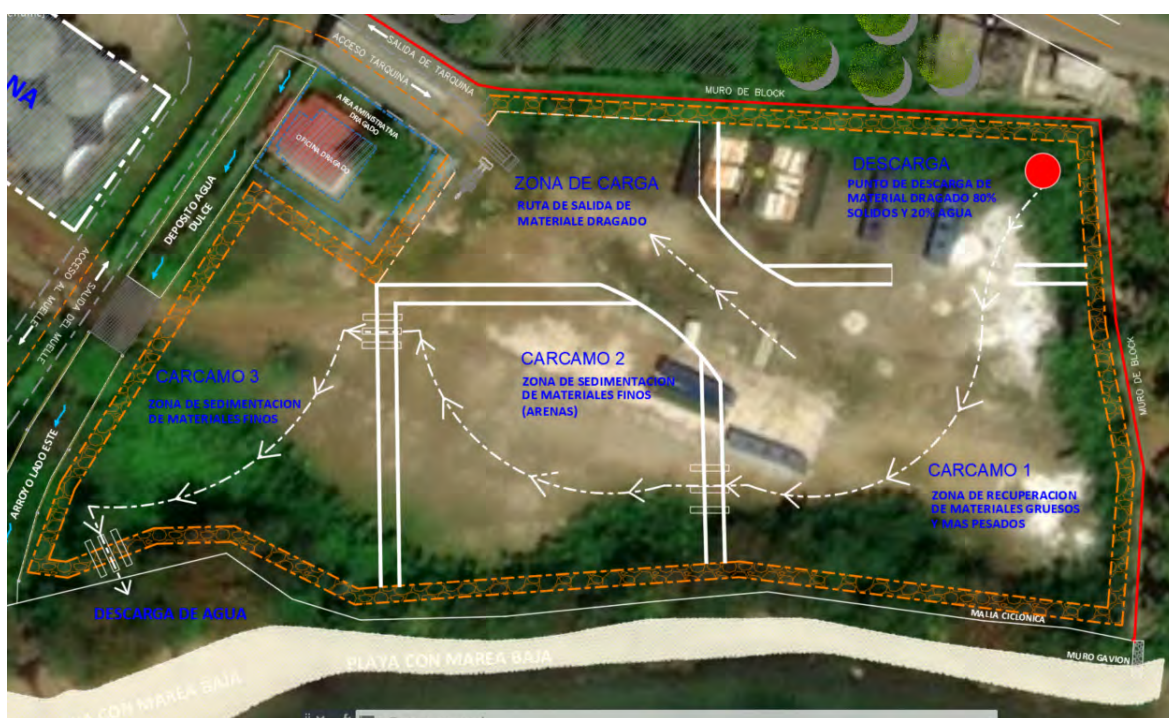
Imagen 69. Esquema de organización en tierra, del área de tarquina para el depósito y decantación de los materiales dragados. Esta área se habilitará al interior de la poligonal en tierra del desarrollo del proyecto.
