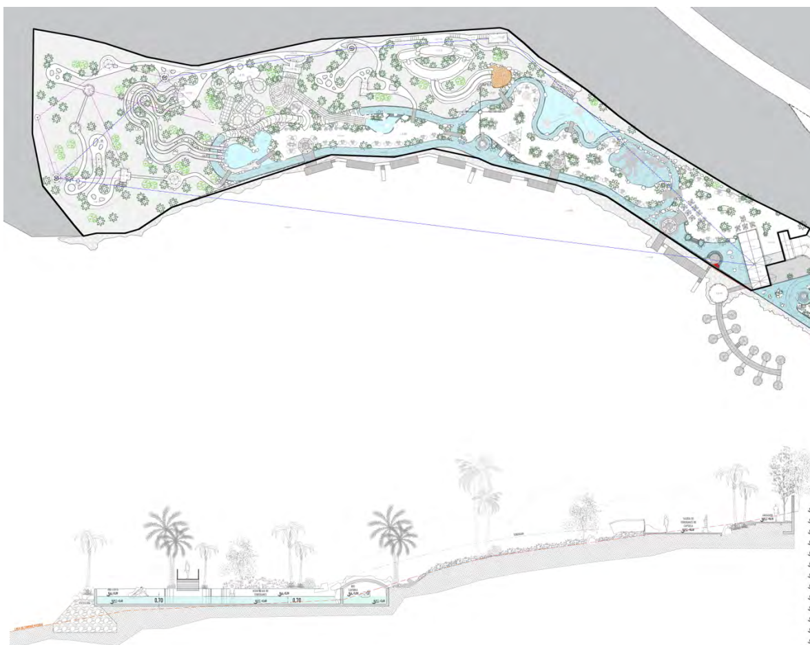
Imagen 45. Sección longitudinal y en planta de propuesta de toboganes de agua, los cuales aprovecharán los desniveles marcados de forma natural del terreno para generar actividades de esparcimiento.
