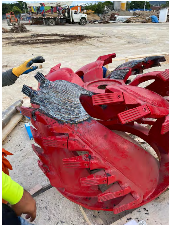
Imagen 67. Cortador sumergible tipo para una draga hidráulica estacionaria.
