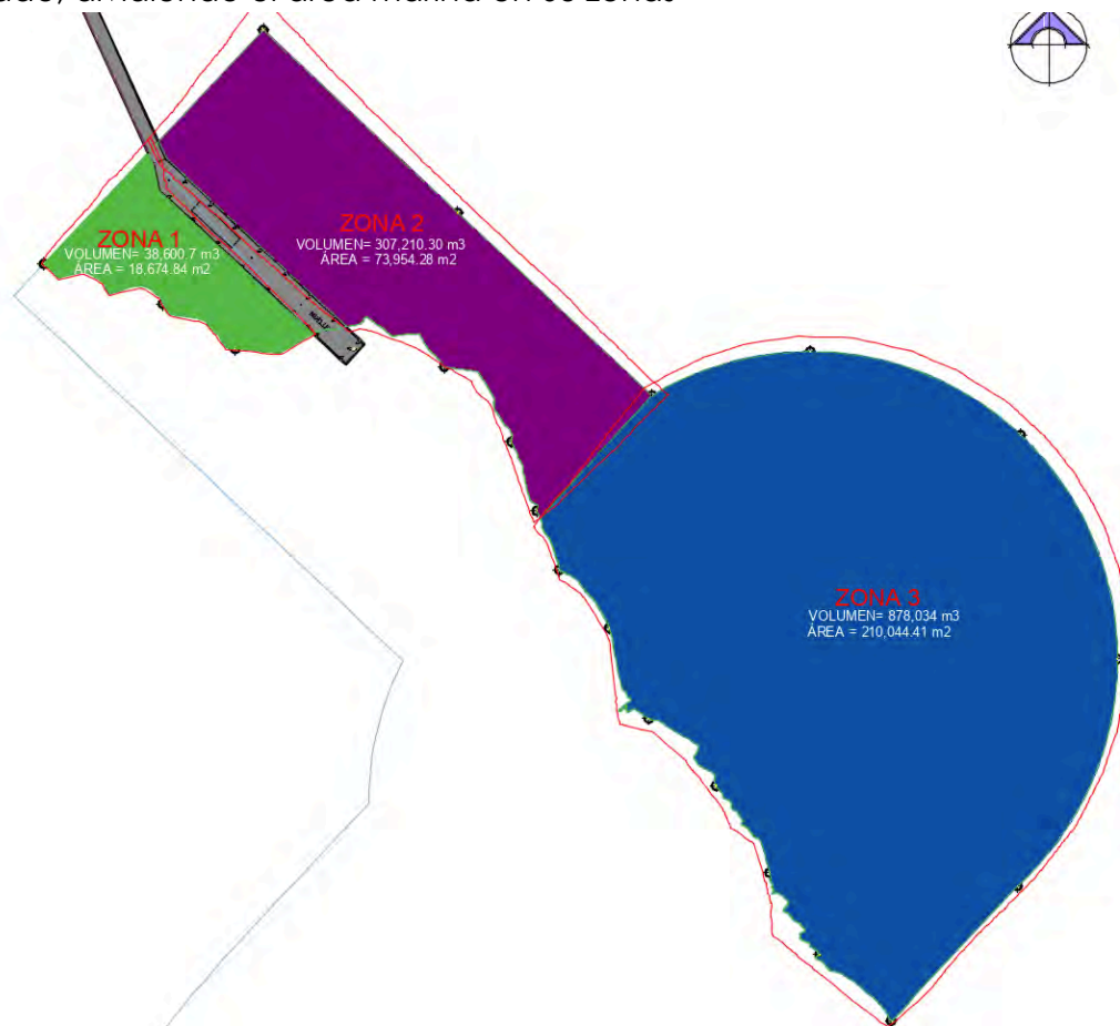
Imagen 61. Esquema general de dársena de maniobras con las 03 zonas de dragado.
