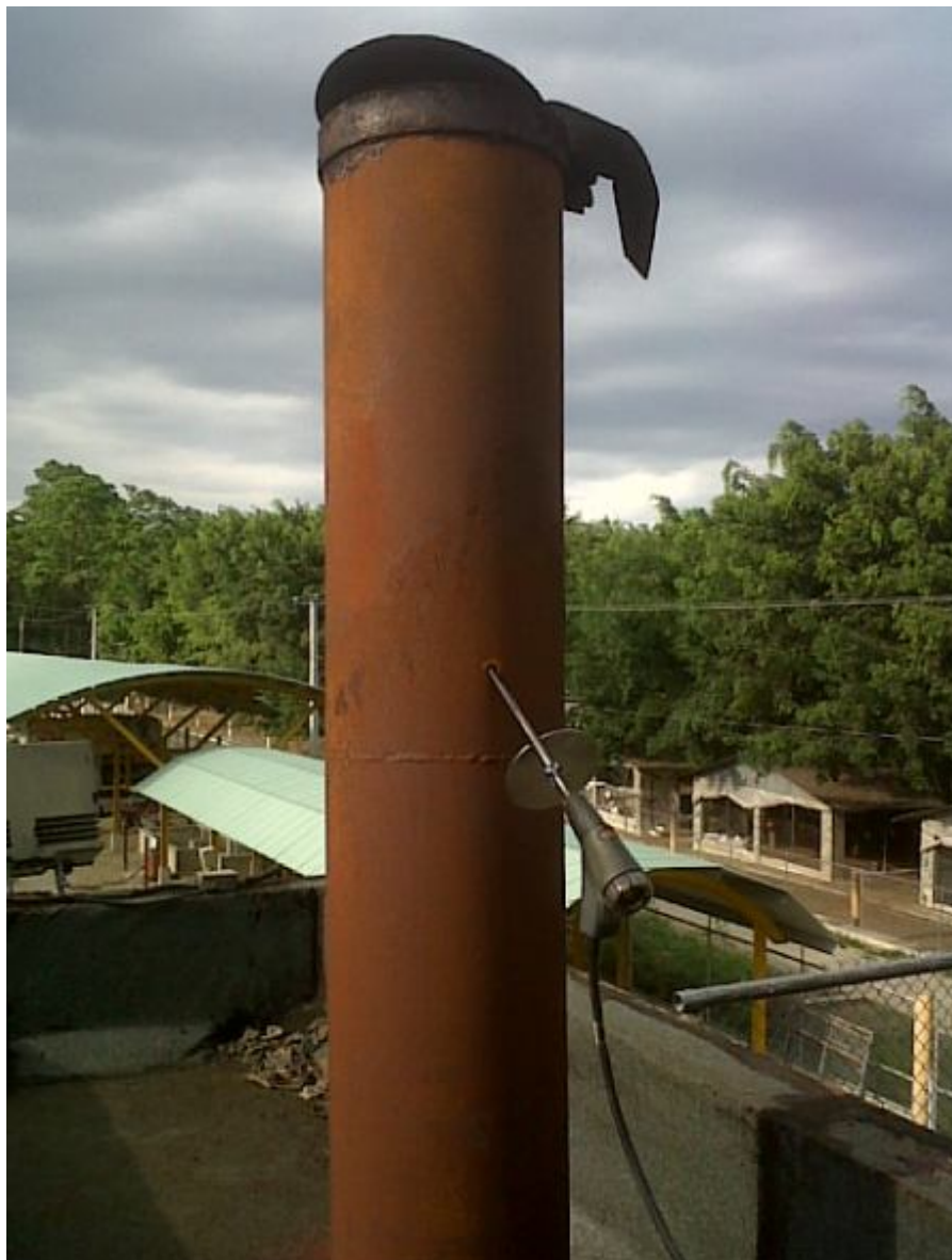
Foto al momento de la medición de gases en chimenea
