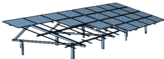
Figura 10. Ejemplo de una estructura fija (4H)
