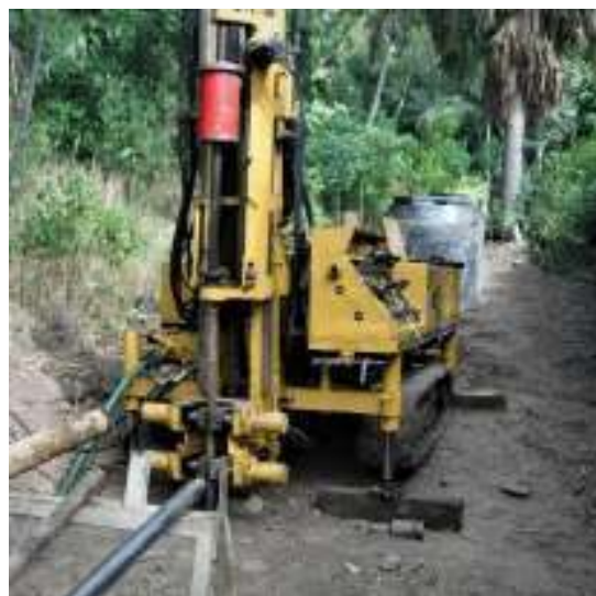
Imagen No. 2-2: Equipo de perforación ROLATEC RL-48L-2010, emplazado el Sondeo No.2
