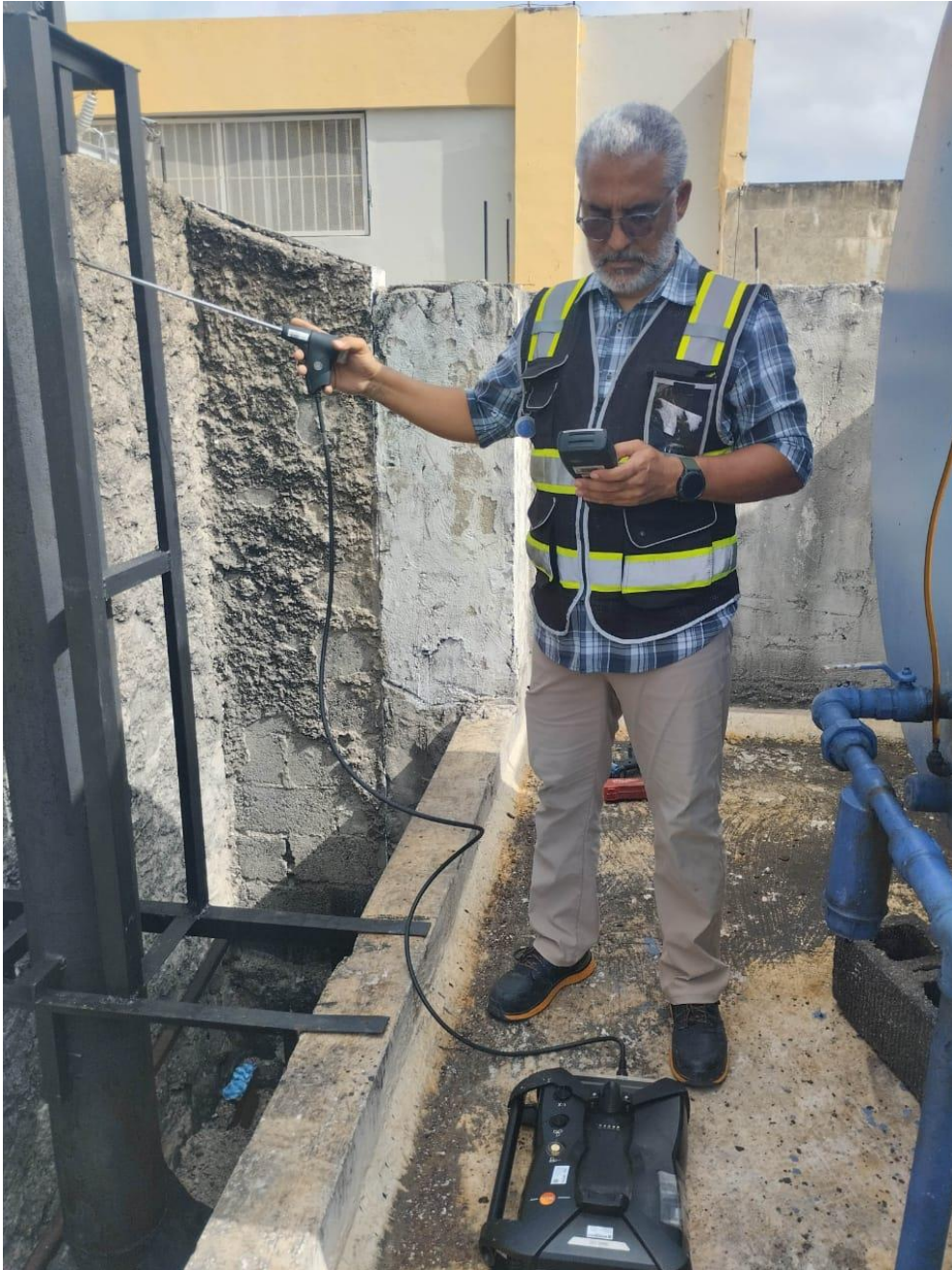
Imagen: procedimiento de medición de opacidad y contaminantes atmosféricos del generador.
