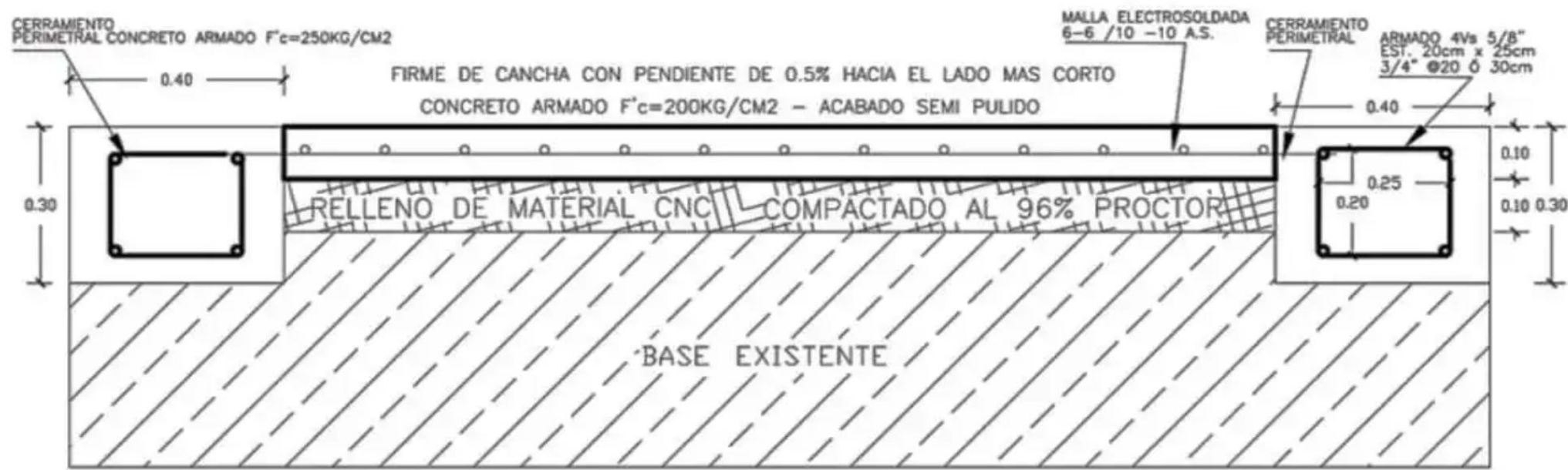
5 A10 DETALLE BASE CANCHA DE PADEL 1:75
