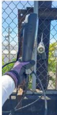
Imagen 5. Foto Mediciones In Situ emisiones gaseosas del generador
