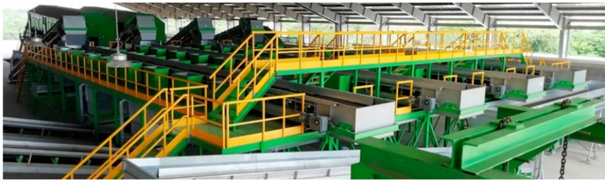
Imagen 5: Planta de clasificación y tratamiento de residuos sólidos domésticos
